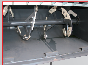
Coclea con raschiatori regolabili. Screw with adjustable scrapers.
