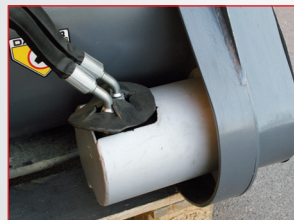
Posizionamento motore. Il motore è posizionato nella parte inferiore della benna. Positioning engine. The engine is located at the bottom of the bucket.
